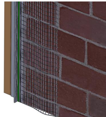
Bild 12a: Anputzprofil einkleben
