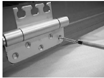
Bild 20: Band mit Türblatt verschrauben
